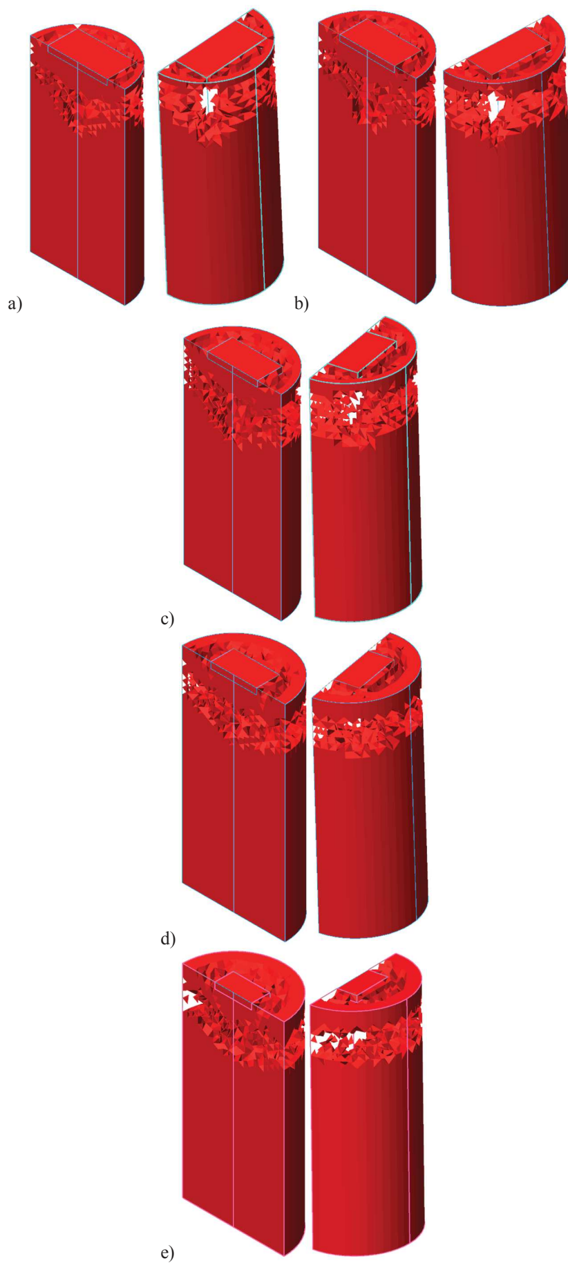
Ryc. 4. Obszary zarysowania i zmiżdżenia betonu a) SC-2.0, b) SC-2.5, c) SC-3.0, d) SC-4.0, e) SC-6.0
